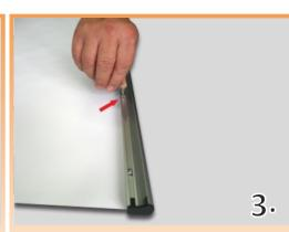
Lištu s grafickým panelem otočte a pomocí přiloženého imbusového klíče dotáhněte šroubky. Tím je grafický panel zajištěn proti vytržení.
